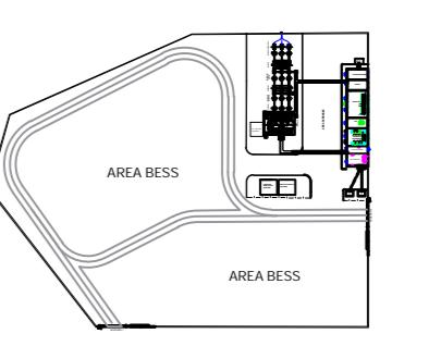
SSE di trasformazione 132/30 kV e area BESS
